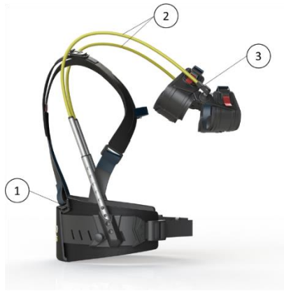
Figure 4 : vue latérale du Hapo ms : (1) Harnais ; (2) Ressorts en composite ; (3) Interface double
