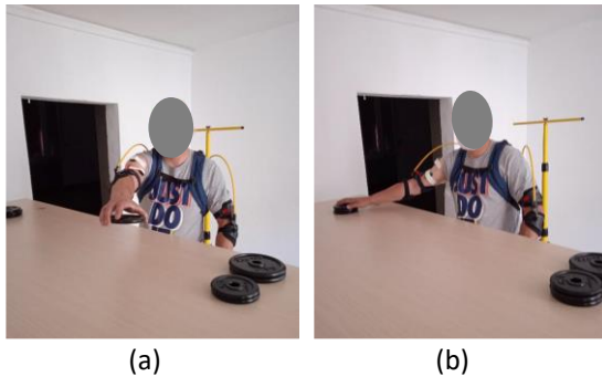
Figure 2 : tâche de manipulation manuelle de poids (6 x 1 kg + 2 x 2 kg) déplacés (a) de gauche à droite ; (b) de droite à gauche
